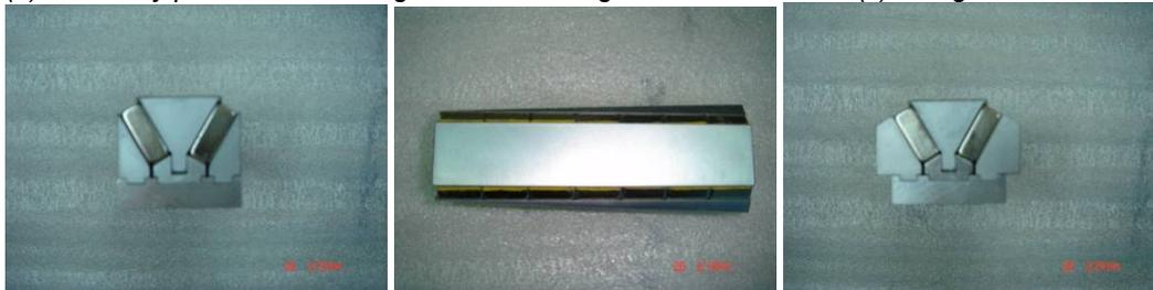
(d) A set of assembled rotor cores and magnets
